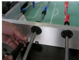
Nun können die Kugellager platziert und die Lagerschalen verschraubt werden.
